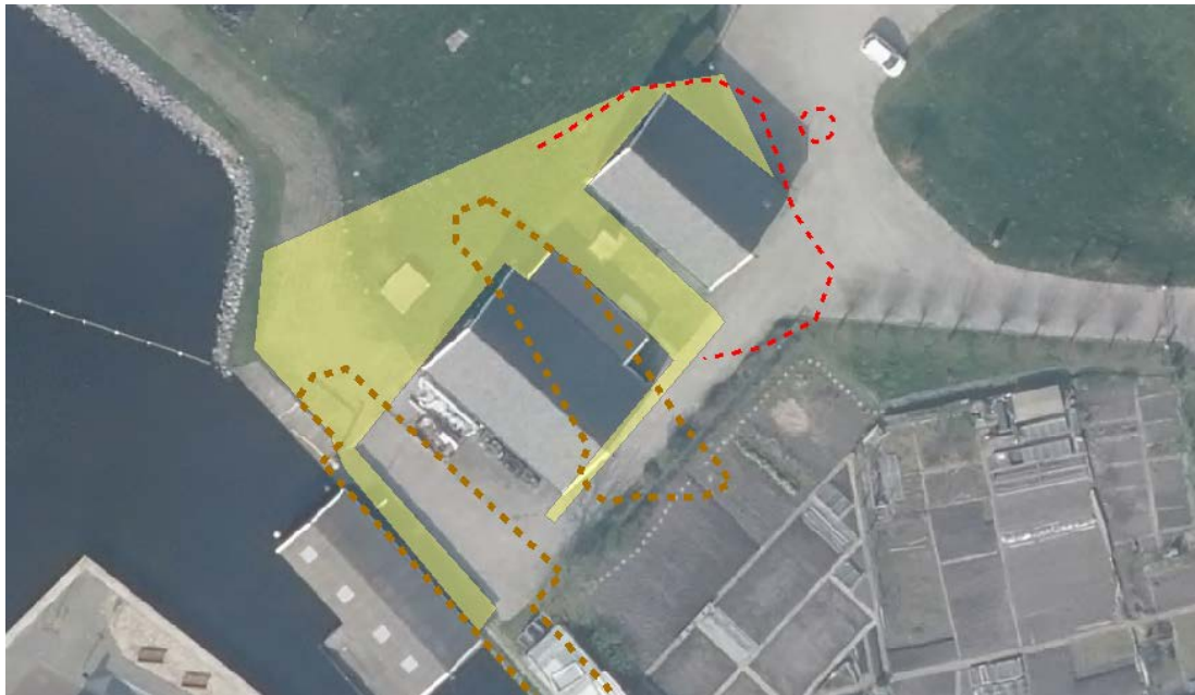
Figuur 4.1 Locatie toekomstige woonkavels t.p.v. loodsen. Geel: Worst case inschatting sterk verontreinigd onverhard oppervlak. Bruin: Interventiewaardecontouren Tjaden 1997. Rood: Interventiewaardecontour Tauw huidig onderzoek.
