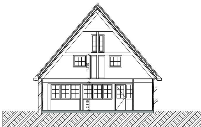
Doorsnede A-A Timmerloods
