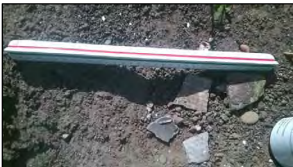
Foto 11: Asbestverdacht materiaal t.p.v. gronddepot
