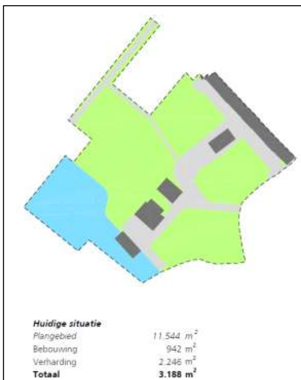
Afbeelding: verharding in bestaande situatie
