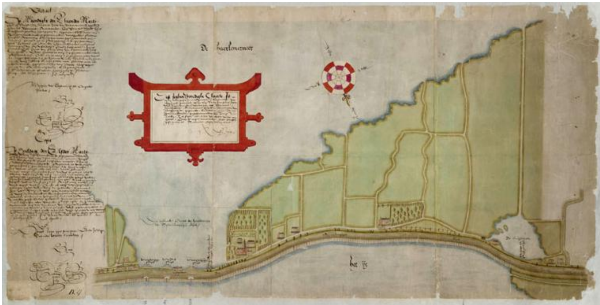
Afbeelding 4: Halfweg en de sluizen in 1608. Zuid is boven. De sluizen liggen op het smalle stuk linksonder op de kaart. Van links naar rechts de Oosterse sluis (1566), Middelsluis (1583) en Westsluis (1558).
